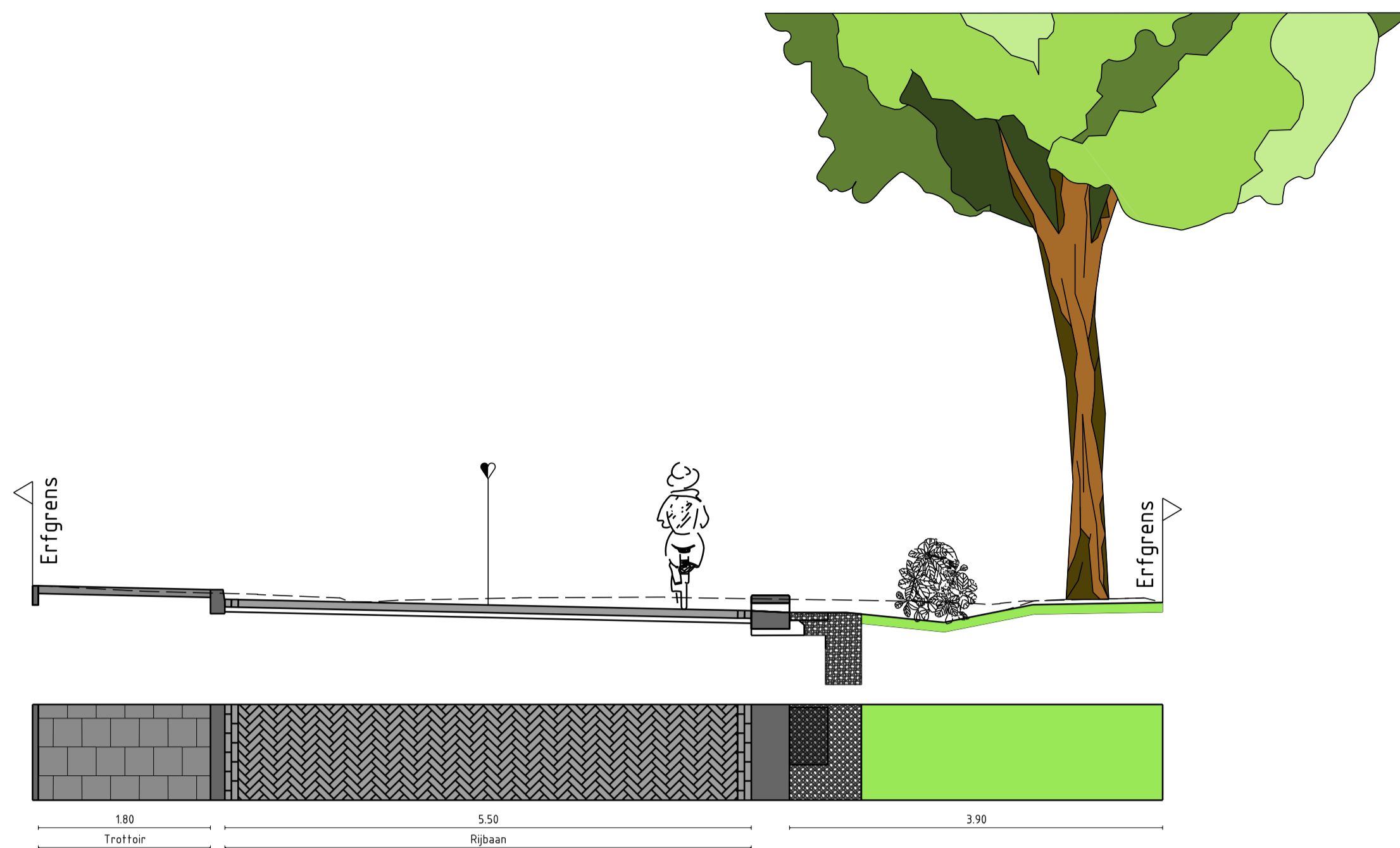
Doorsnede I-I: t.h.v. Sportlaan 20 met grindkoffer Schaal 1:50
