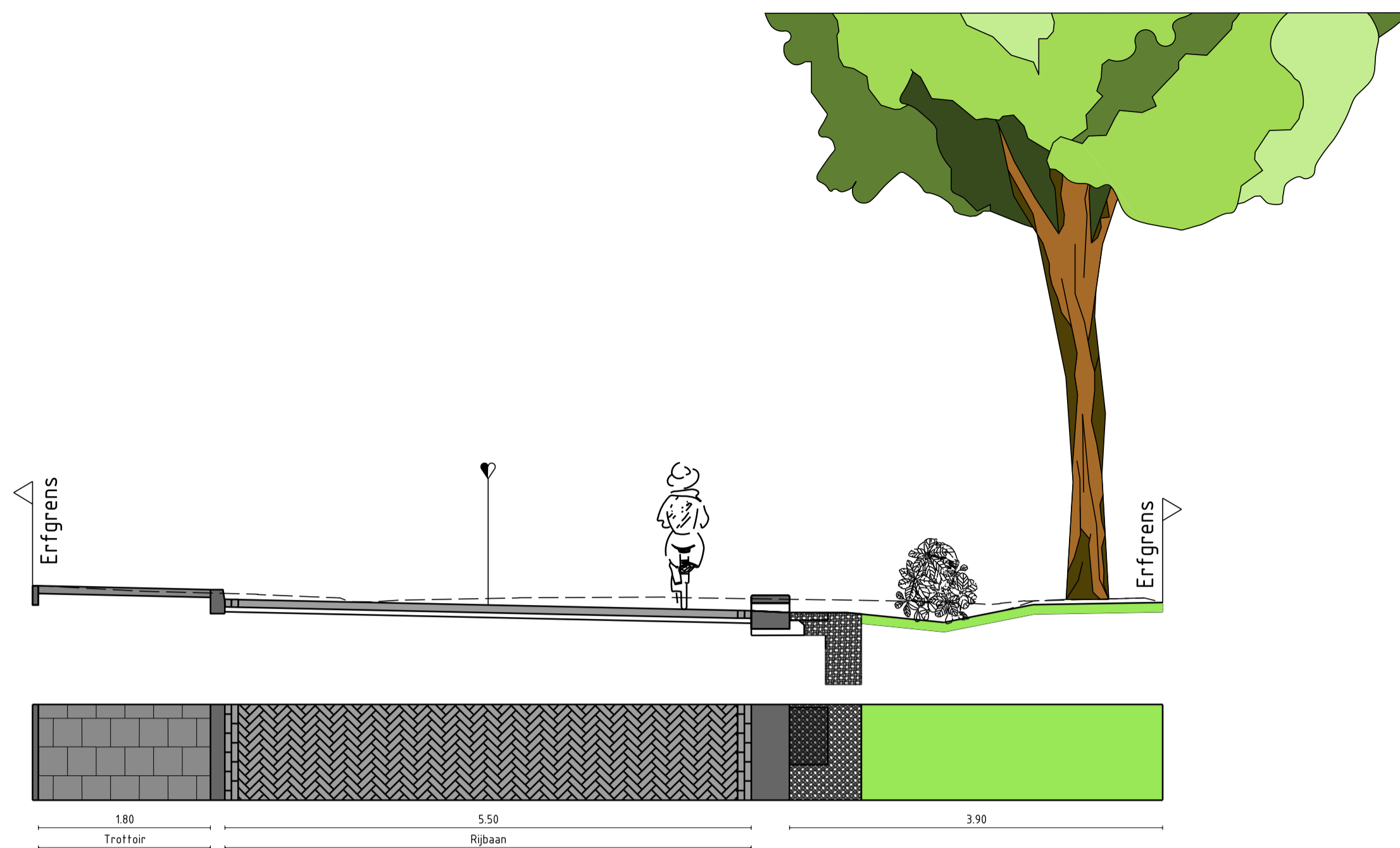
Doorsnede I-I: t.h.v. Sportlaan 20 met grindkoffer Schaal 1:50
